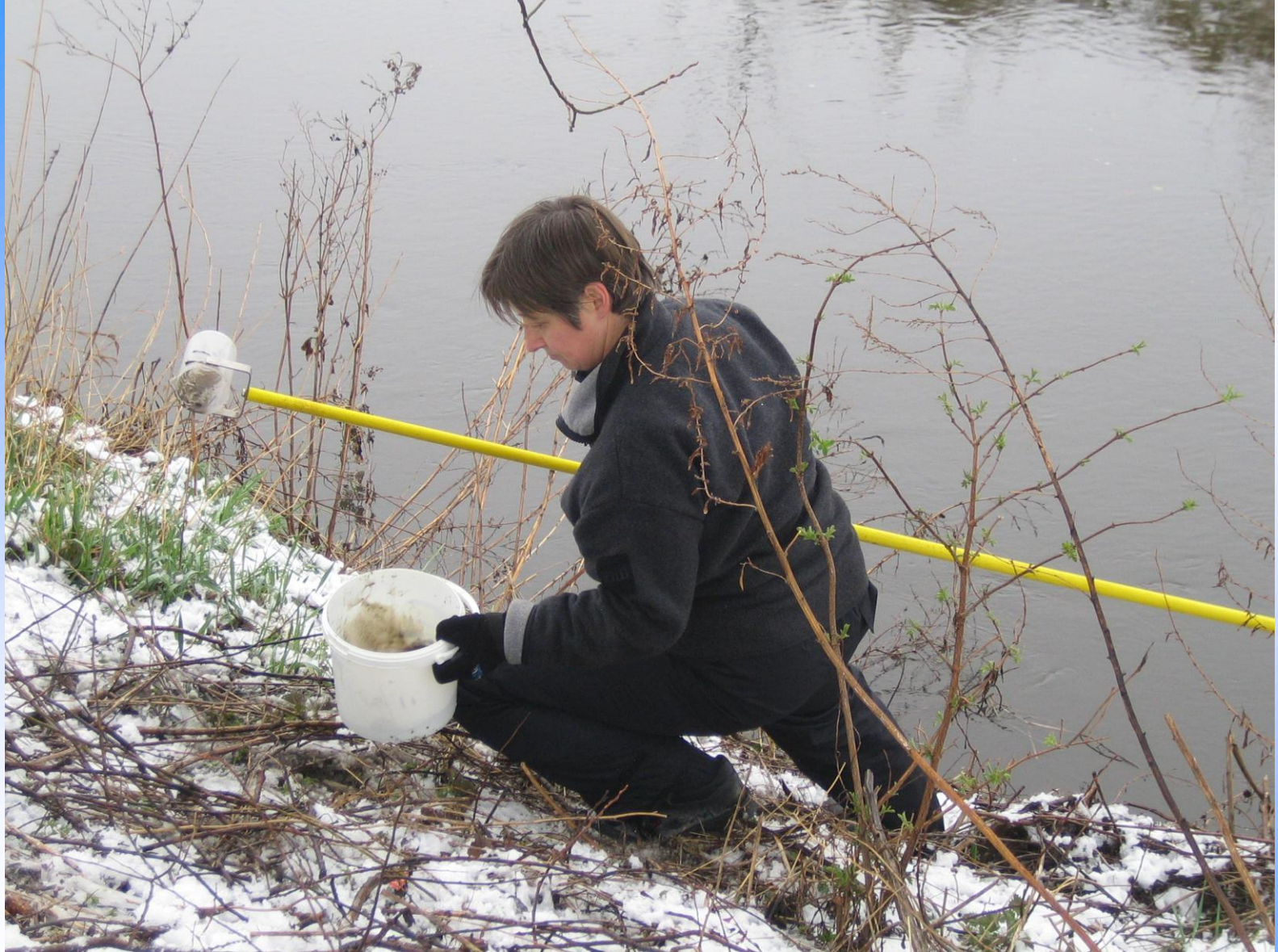
Entnahme einer Sedimentsprobe
